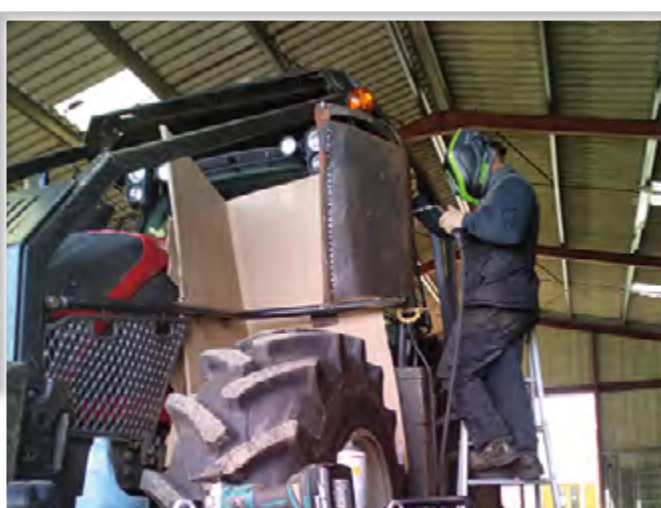
Renforcement du blindage du tracteur forestier
